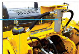
Lọc bổ xung với cảm biến báo tắc lọc
